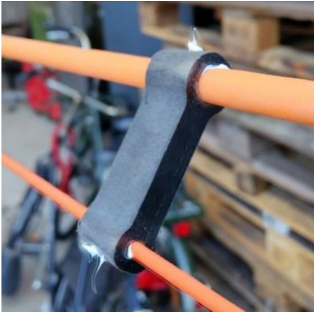
Figuur 4.6: Constructie van de meetopstelling met passieve (onder) en actieve (boven) kabels uit elkaar gehouden op een vaste afstand van 40 [mm] door kunststof standhouders geplaatst met een interval van 1 [m].
