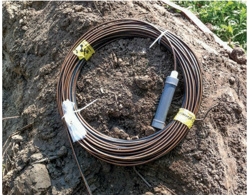
Een optische glasvezelkabel wordt op verschillende locaties over de gehele diepte van het bodemenergiesysteem in de grond gebracht. Met laserpulsen worden de bodemtemperaturen over de lengte van de gehele kabel continu gemeten.
